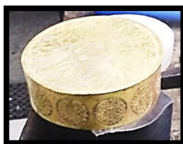
٦-مرحلة تجميع العلبه بواسطة استخدام لحم الفضة باستخدام البوراكس او التنكار
