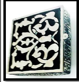
١٠- مرحلة طلاء العلبه بالفضة من خلال الترسيب الكهربائي وألوان المينا السوداء .
