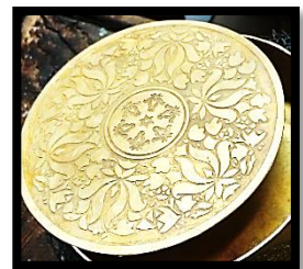
٤-مرحلة عمل الفيلم إستعدادا للحفر الحمضي الكيميائي
